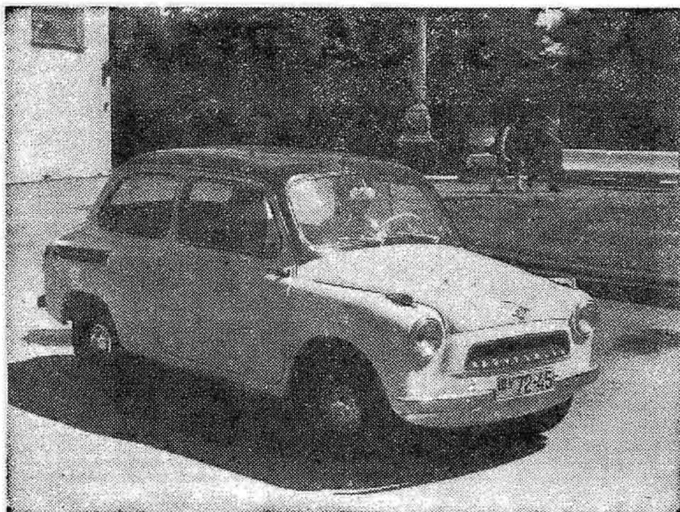
Auto de pequeña cilindrada: el Zaporozhets, recorre 100 kilómetros con 6 litros de gasolina.
